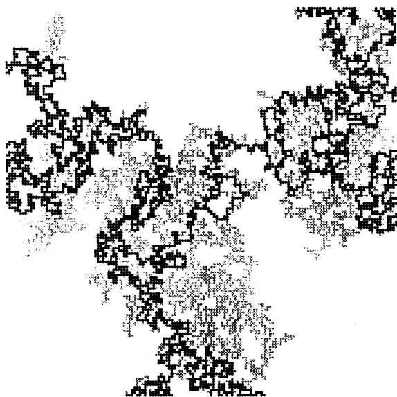
РИС. 7.13. Перколяционный кластер и его остов (черный цвет) по результатам моделирования на квадратной решетке размером 147 \times 147 при p_c = 0,593 [168].
