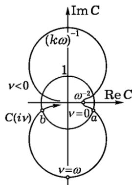
Рис. 190. Зависимость комплексной амплитуды от частоты внешней силы
