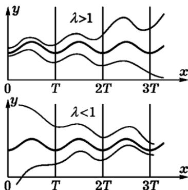
Рис. 45. Установление вынужденного колебания
