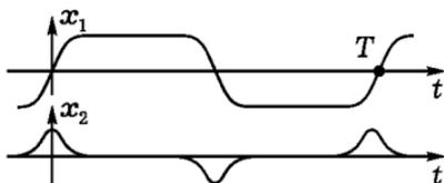
Рис. 108. Угол отклонения маятника и скорость его изменения при амплитуде, близкой к  $\pi$
