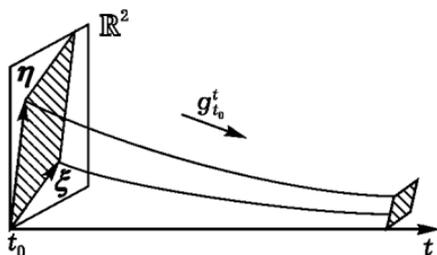
Рис. 198. Фазовый поток асимптотически устойчивой линейной системы
