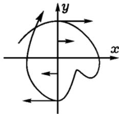
Рис. 201. Фазовая плоскость уравнения  $\ddot{x} + q(t)x = 0$
