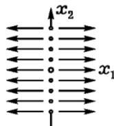
Рис. 32. Фазовые кривые системы  $\dot{x}_1 = x_1$ ,  $\dot{x}_2 = 0$
