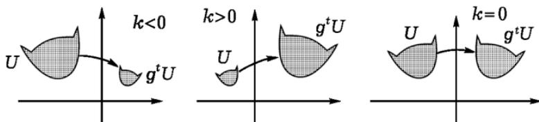
Рис. 114. Поведение площадей при преобразованиях фазового потока уравнения маятника
