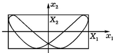
Рис. 181. Одна из кривых Лиссажу с  $\omega_2 = 2\omega_1$
